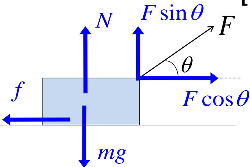
[解法一]  $\vec{J}_{\text{合力}} = \Delta \vec{P} \rightarrow \Delta \vec{P} = \vec{F}_{\text{合力}} \times \Delta t$
